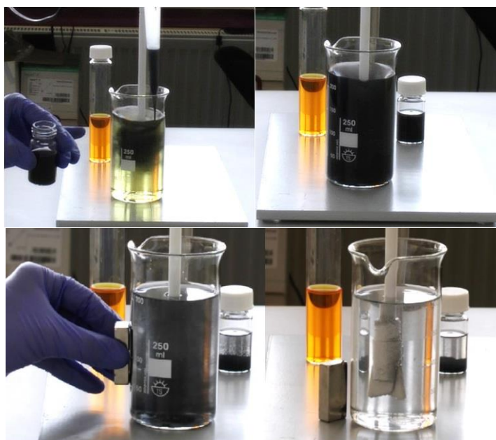
Obrázek 22. Čištění kontaminované vody nanočásticemi železa (Zdroj: Lucie Kolářová)
