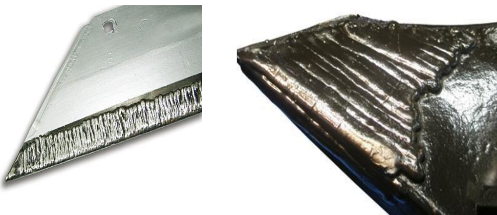
Obr. 4: Kolmý návar na ostří čepel (vlevo) a návar na hrot podrýváku (vpravo)
