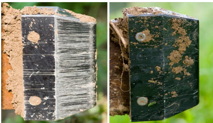
Obr. 5: Polní zkouška u špičky radlice (vlevo bez povlaku, vpravo s povlakem)
