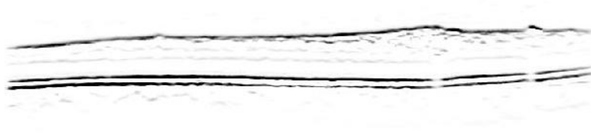
Obrázek 36 – Invertovaná hodnota vah, na jejichž základě se určí, o kterou vrstvu se v případě prvních třech (hlavních) vrstev jedná
