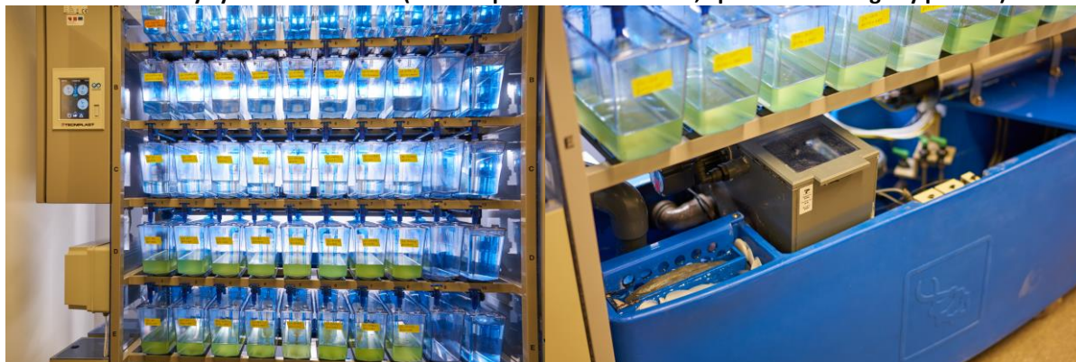
Obrázek 5 – Chovný systém Active Blue (vlevo experimentální nádrže, vpravo technologický prostor)
