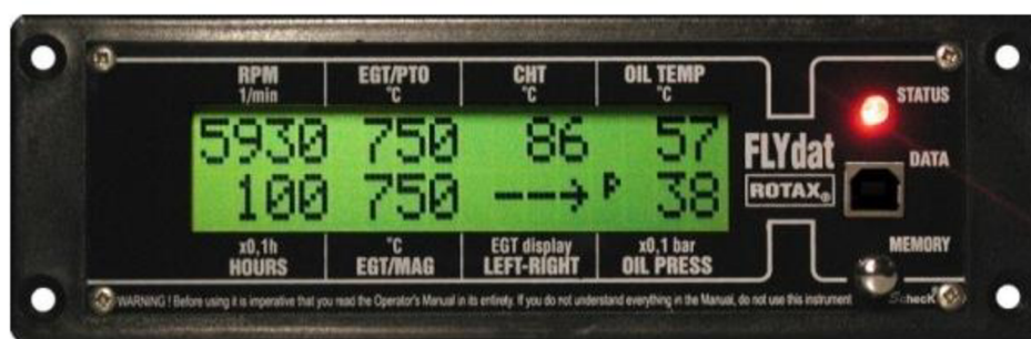
Obrázek 2.24 Systém FLYDAT představující zařízení zobrazující pouze číselné hodnoty jednotlivých veličin.
