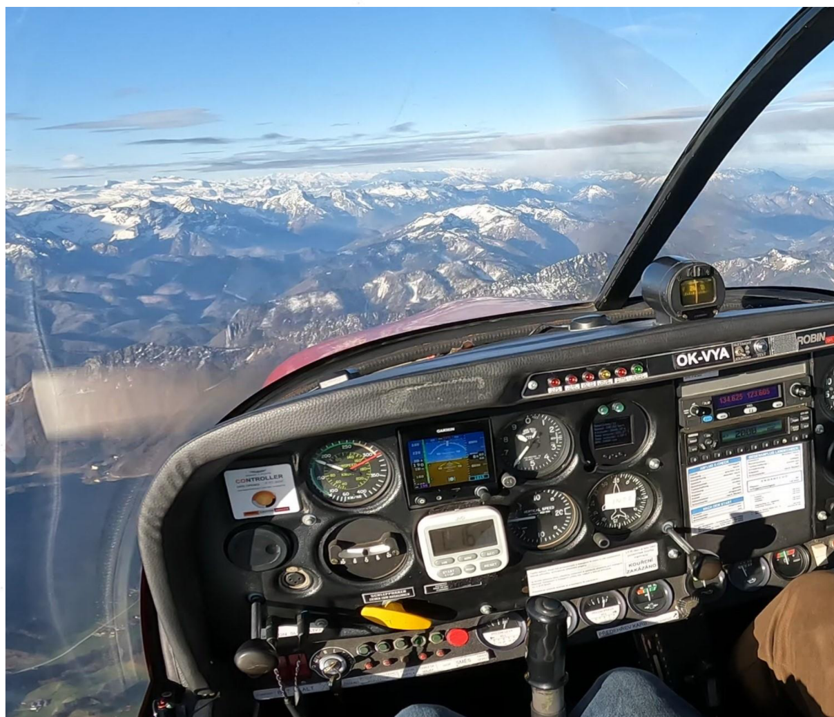
Obrázek 2.20 - Reálné testy zařízení ukázaly, že čitelnost displeje je i na přímém slunci dostatečná a přibližně shodná s jinými avionickými zařízeními
