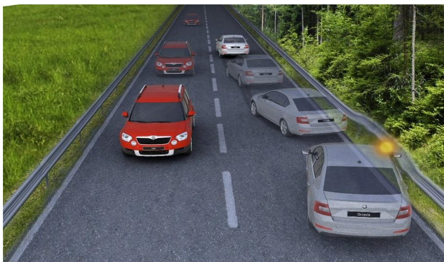
Obrázek 8: Funkce multikolizní brzdy [34]
