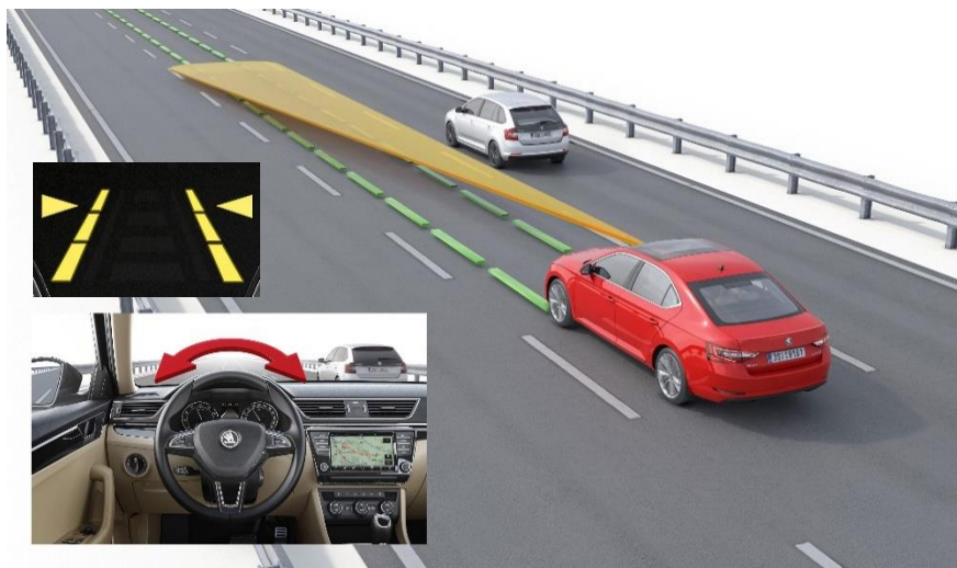
Obrázek 10: Princip činnosti udržování vozidla uprostřed jízdního pruhu [42]
