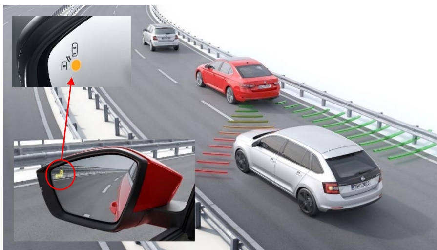
Obrázek 9: Princip činnosti hlídání mrtvého úhlu [36]
