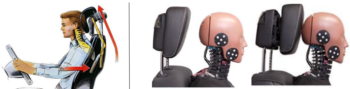
Obrázek 21: Princip aktivní hlavové opěrky [81] Mechanická (vlevo) a elektronicky ovládaná (vpravo).
