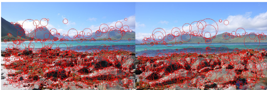
Obrázek 3.1: Detekce významných bodů pomocí algoritmu SURF (1287 a 1044 bodů)
