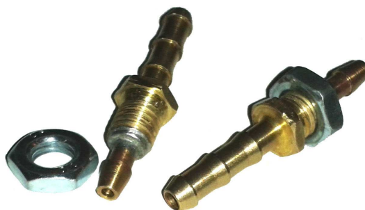
Obrázek 3.23 Průchodky a přípojovací porty tlaků.
