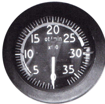
Obrázek 2.6 Princip a zobrazení otáčkoměru. Převzato z [5].
