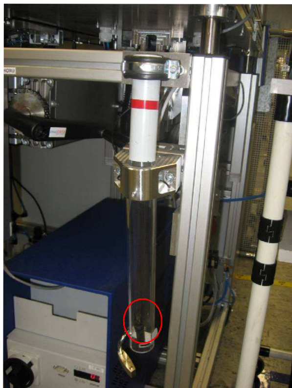
Obr. č. 16 Propadová šachta
