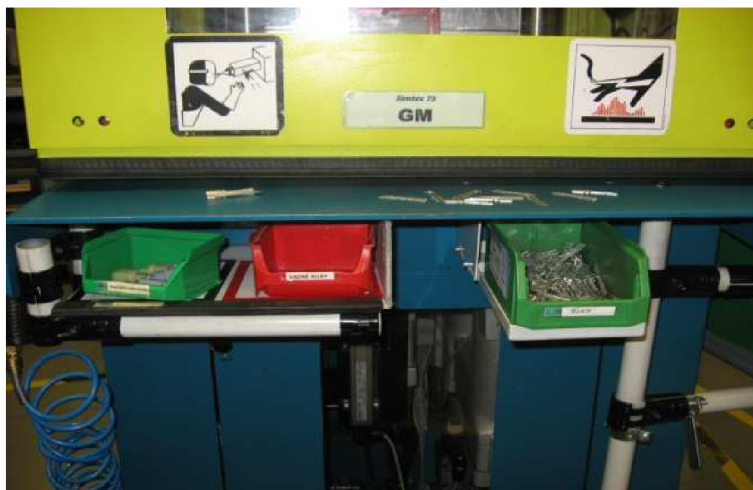
Obr. č. 32 Ukládání vadných kusů ve stroji – vstřikolis
