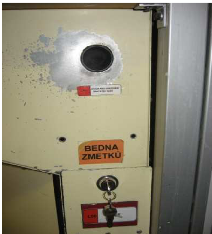
Obr. č. 35 Ukládání vadných kusů ve stroji – montážní automat
