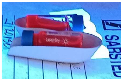
Obr. 25 - Fluorescence hypericinu při působení UV záření ( \lambda=365 nm)
