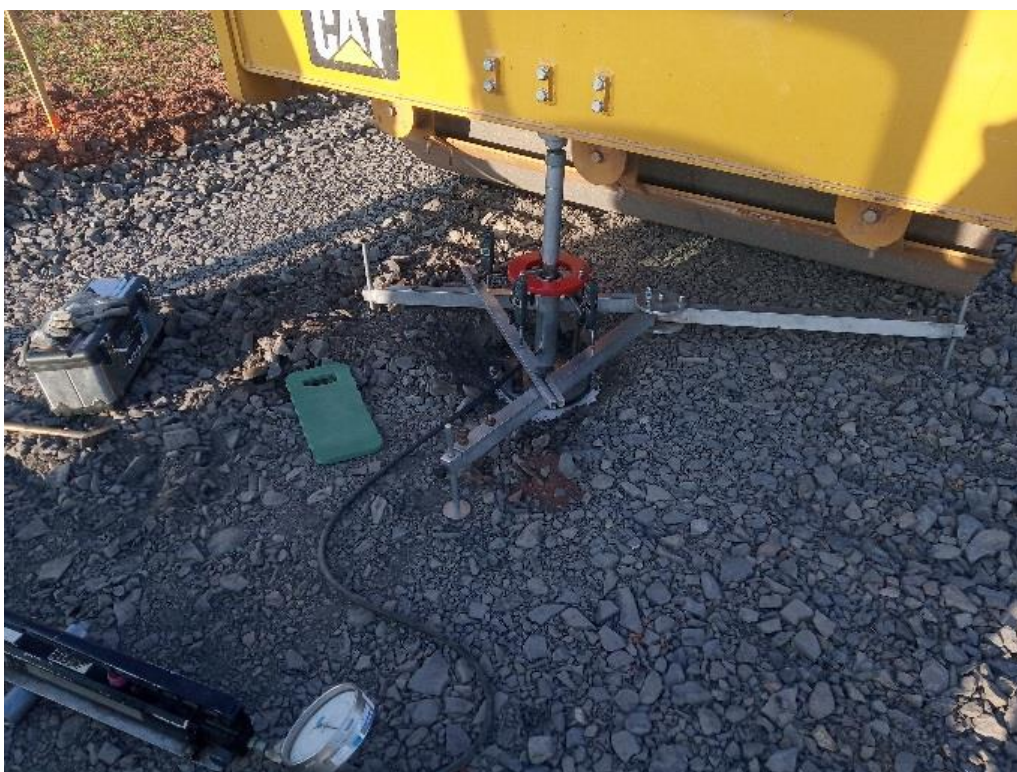
Cesta VPC 8 – hutní zkoušky na zemní pláni
