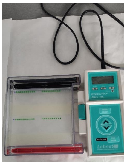
Obr. č. 7 Elektroforetická vana s agarózovým gelem a napipetovanými vzorky
