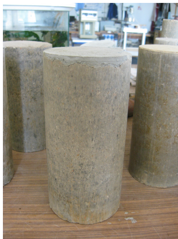
Obrázek 15: Vzorek recyklátu smíšeného zarovnaný samonivelační stěrkou
