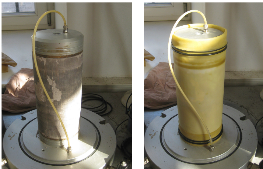
Obrázek 10: Upínání vzorku do přístroje - vzorek s porézními destičkami (vlevo) a vzorek s membránou a O kroužky (vpravo)
