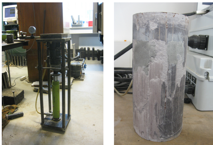
Obrázek 16: Vytlačování vzorku z formy pomocí otočeného lisu a vzorek elektrárenského popílku zadělaný samonivelační stěrkou
