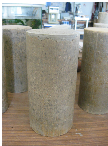
Obrázek 15: Vzorek recyklátu smíšeného zarovnaný samonivelační stěrkou
