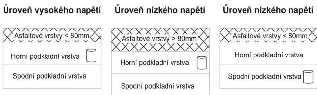
Obrázek 5: Volba úrovně napětí dle umístění ve vozovce [3]
