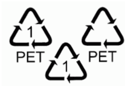
Obr. 1 Značení obalů z polyethyléntereftalátu ( http://www.veronica.cz/ )
