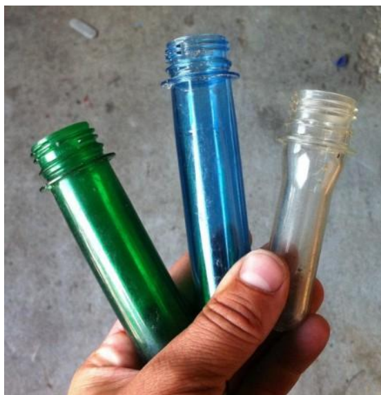
Obr. 5 Preformy PET láhví ( http://www.hottech.cz/ )
