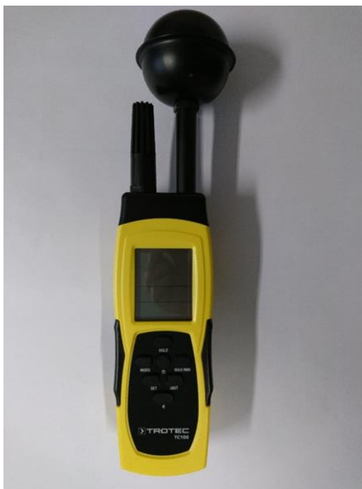
Obrázek 3 Termohygrometr TROTREC TC100 [Zdroj: Vlastní]
