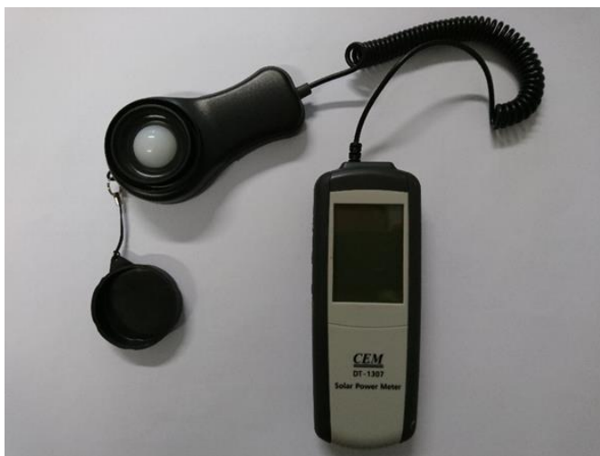
Obrázek 4 Měřicí přístroj pro měření intenzity slunečního záření CEM DT-1307 [Zdroj: Vlastní]
