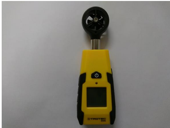
Obrázek 1 Vrtulový anemometr TROTEC BA06 [Zdroj: Vlastní]
