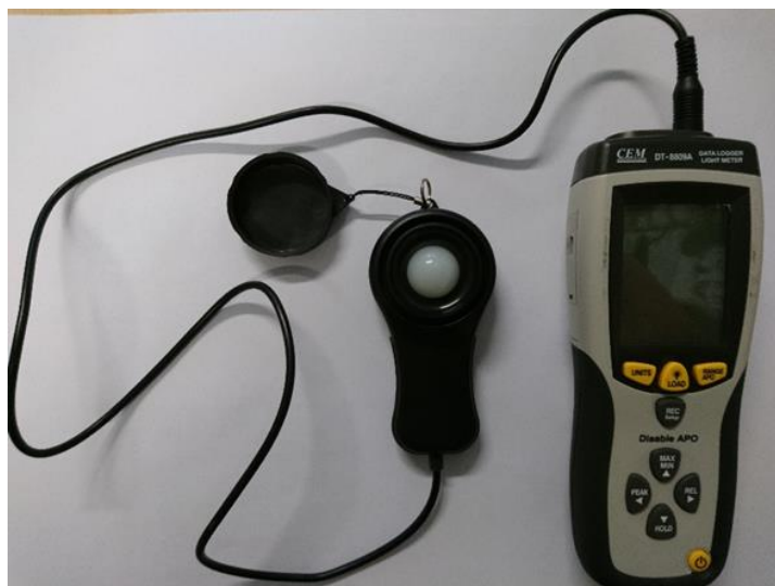
Obrázek 5 Luxmetr CEM DT-8809A [Zdroj: Vlastní]
