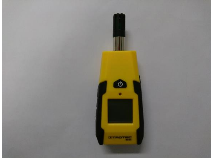
Obrázek 2 Termohygrometr TROTEC BC06 [Zdroj: Vlastní]
