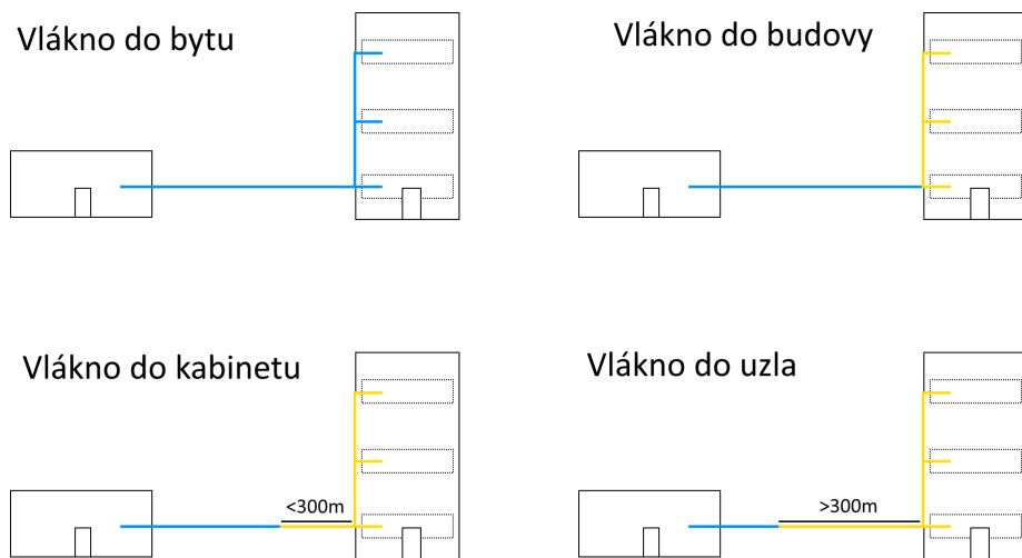
Obr. 1.1: Porovnanie rôznych druhov FTTx [5]
