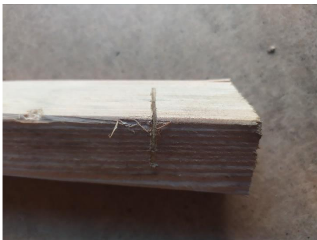
Obr. 19 Stopa pily ve dřevě 106
