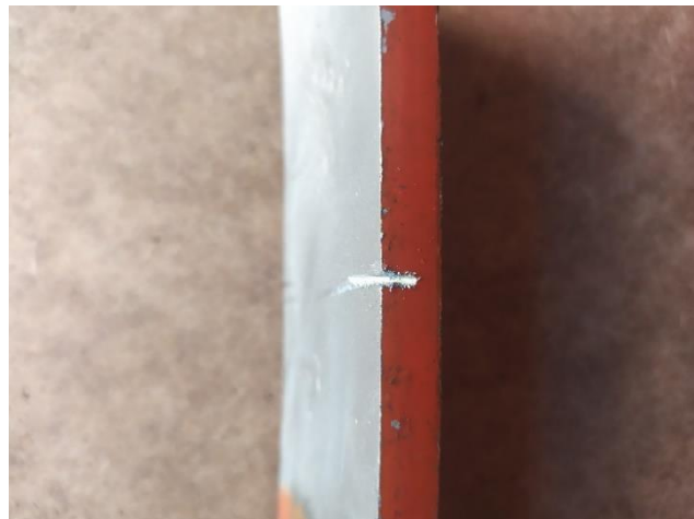
Obr. 20 Stopa pily v kovu 107
