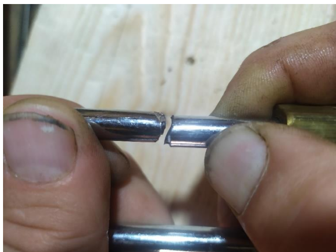
Obr. 25 a 26 Visací zámek přeštipnutý pákovými kleštěmi a dané pákové kleště 118
