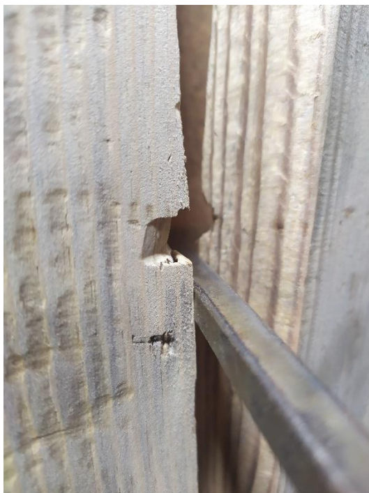
Obr. 23 a 24 Stopy po páčení čtyřhrannou a osmihrannou montážní pákou 112
