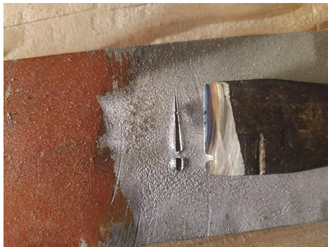
Obr. 18 Stopa sekáče v kovu 103
