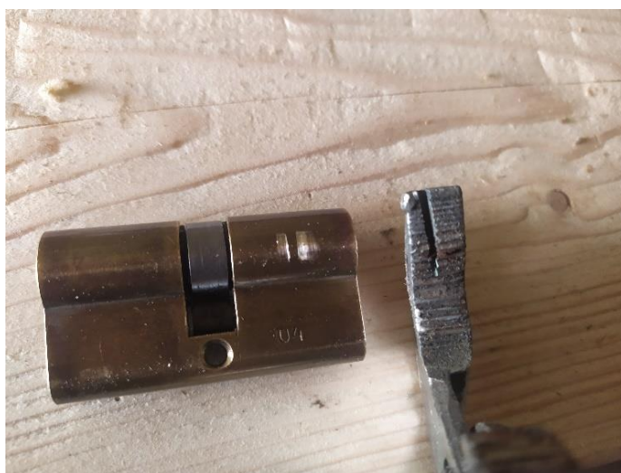
Obr. 27 Stopa od hasáku na cylindrické vložce 119
