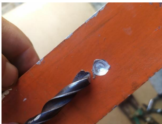
Obr. 21 Stopa šroubovitého vrtáku v kovu 108
