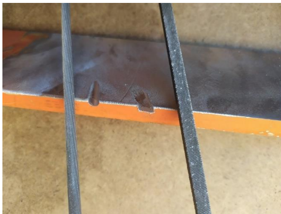
Obr. 22 Stopy pilníků v kovu 110
