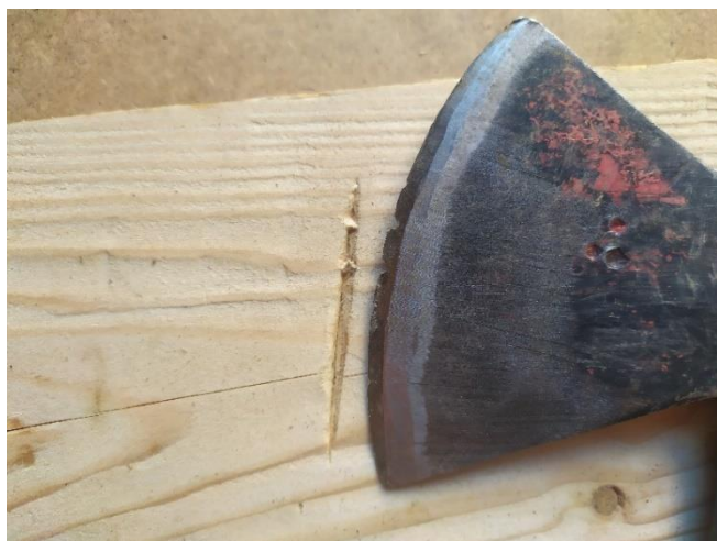
Obr. 17 Stopa sekery ve dřevě 102
