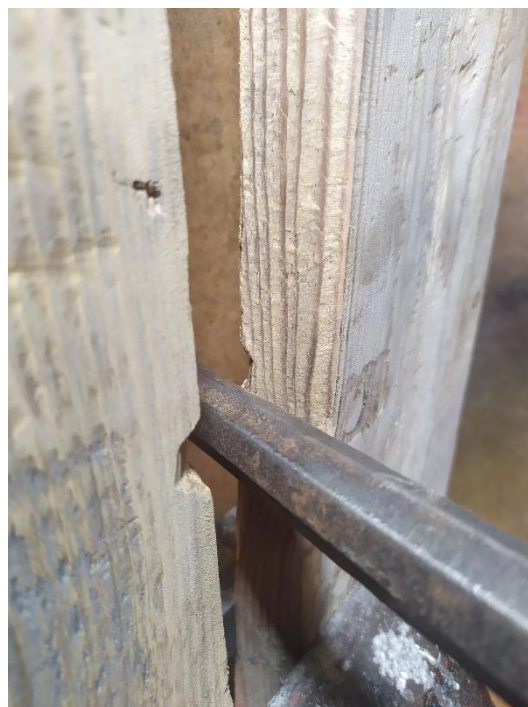
Obr. 23 a 24 Stopy po páčení čtyřhrannou a osmihrannou montážní pákou 112
