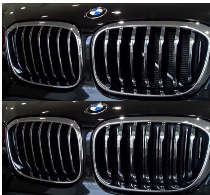
Obr. 13 Aktívne mriežky vozidla BMW, otvorené (hore) a zatvorené (dole) [9]
