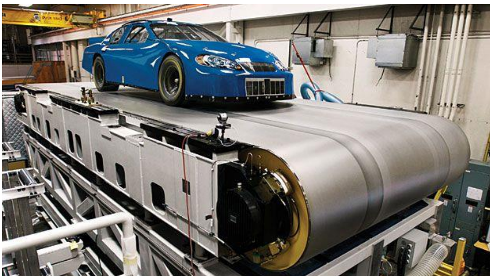
Obr. 14 Pohybujúci sa pás, schopný simulovať jazdu až do 290 km/h [14]
