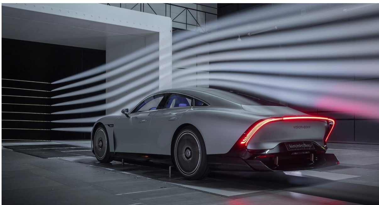
Obr. 15 Dymové prúdy znázorňujúce prúdenie okolo vozidla Mercedes-Benz [13]
