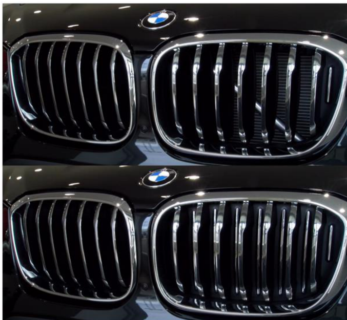
Obr. 13 Aktívne mriežky vozidla BMW, otvorené (hore) a zatvorené (dole) [9]
