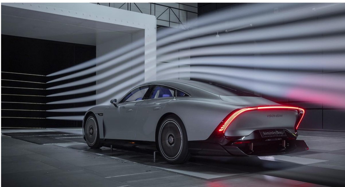
Obr. 15 Dymové prúdy znázorňujúce prúdenie okolo vozidla Mercedes-Benz [13]
