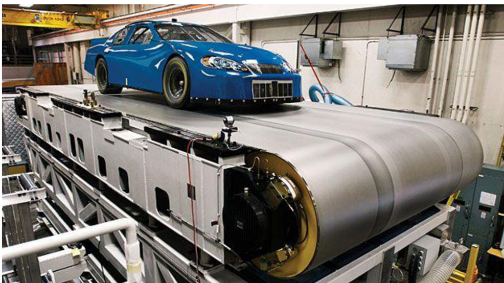
Obr. 14 Pohybujúci sa pás, schopný simulovať jazdu až do 290 km/h [14]
