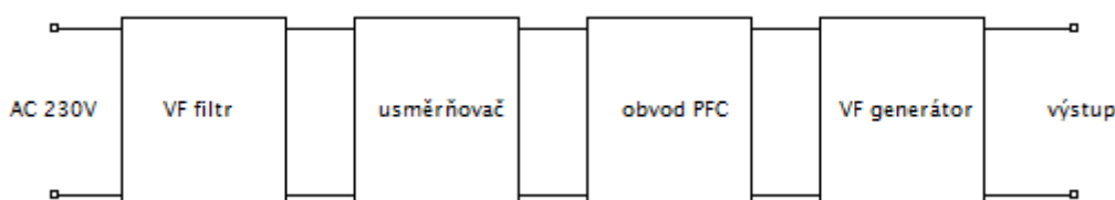
Obr. 4-1 Blokové schéma předřadného systému pro bezelektrodové zářivky
