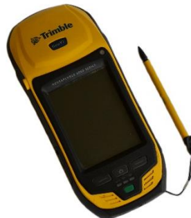
Obr. č. 8 – Přístroj GPS Trimble GeoXT 6000 (Autor: Kofránková Petra)
