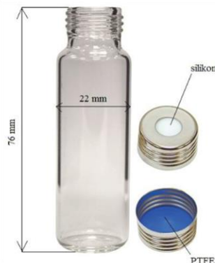
Obr. 8 Vialka o objemu 20 ml pro uložení analytického vzorku před testováním pomocí HS-SPME
