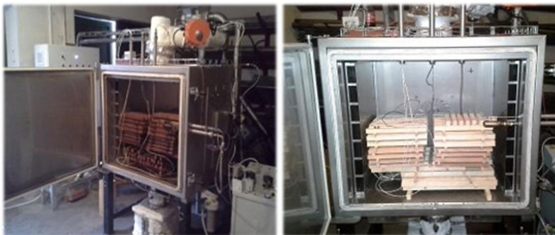
Obr. 5 Vzorky dřeva v termické komoře před a po termické modifikaci
