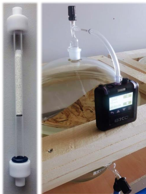
Obr. 10 Trubička se sorbentem Tenax TA ® pro termální desorpci a odběr vzorku vzduchu pomocí mobilního odběrového čerpadla
