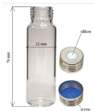
Obr. 8 Vialka o objemu 20 ml pro uložení analytického vzorku před testováním pomocí HS-SPME
