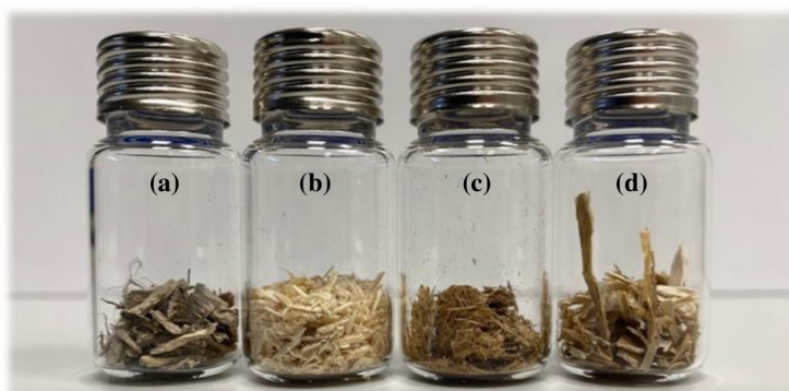
Obr. 11 Vzorky v uzavřených vialkách určené k analýze pomocí HS-SPME/GC-MS: (a) konopné pazdeří (ref.), (b) roztřískovaná dřevní štěpka, (c) deska z rákosu totora, (d) řepková řezanka
