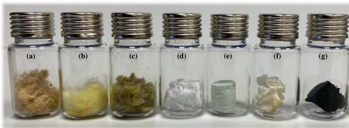
Obr. 12 Vzorky v uzavřených vialkách určené k analýze pomocí HS-SPME/GC-MS: (a) měkká dřevovláknitá deska, (b) skelná vata, (c) minerální vlna, (d) expandovaný polystyren, (e) extrudovaný polystyren, (f) PUR pěna, (g) kaučuková izolace
