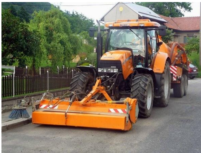
Obr. 8) Upevnění zametače do předního tříbodového závěsu [5]
