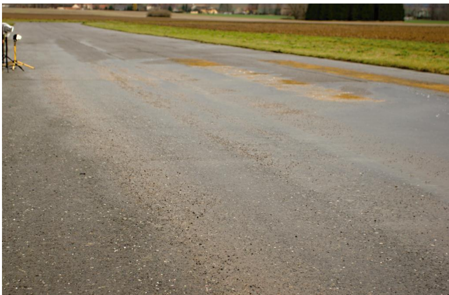
Obr. 38) Pole s různými počty průjezdů
