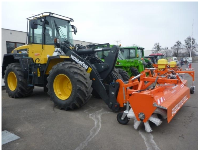
Obr. 10) Uložení zametače na ramenech nakladače [4]
