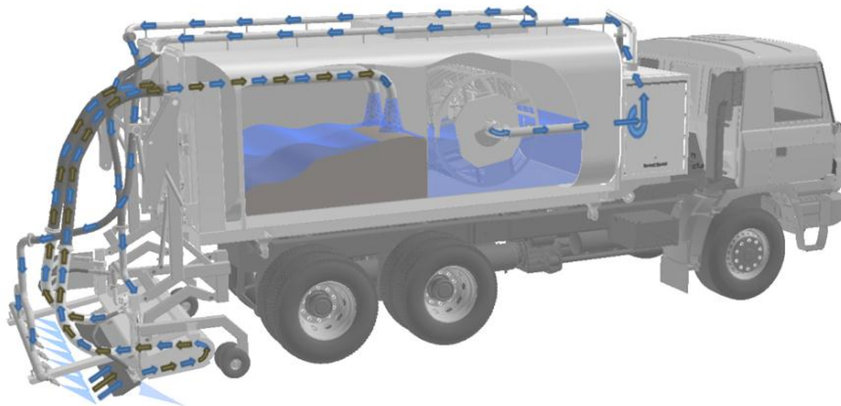
Obr. 31) Funkční schéma nástavby MySaN
