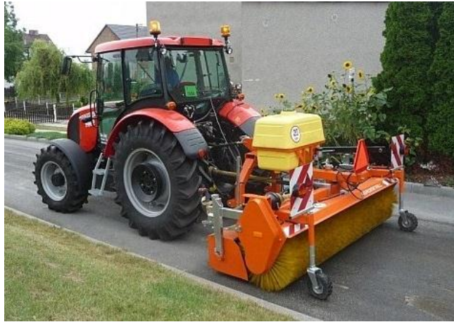
Obr. 9) Upevnění zametače do zadního tříbodového závěsu [5]
