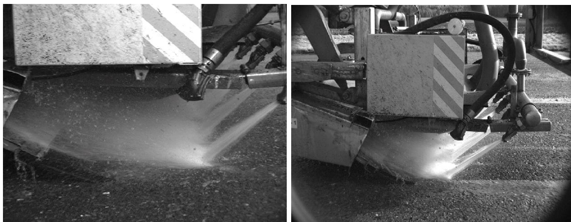
Obr. 34) a) Chybně nastavený úhel, b) Optimální nastavení úhlu
