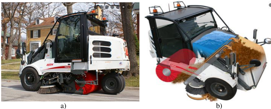
Obr. 12) a) Tříkolový zametací samosběr firmy Elgin, b) Funkční princip zametacího stroje Elgin Pelican [8]
