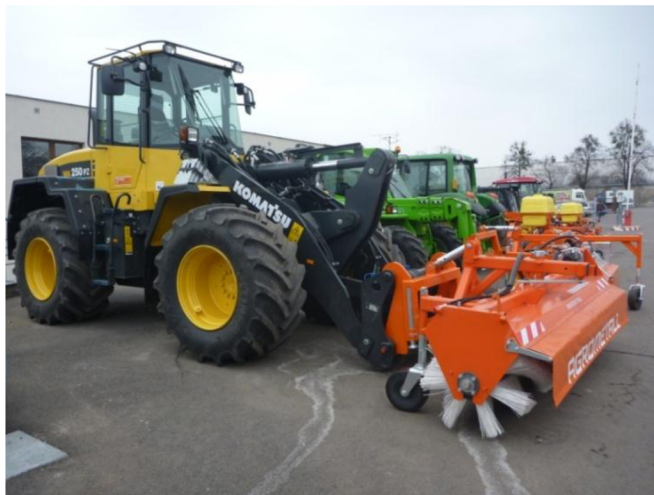
Obr. 10) Uložení zametače na ramenech nakladače [4]
