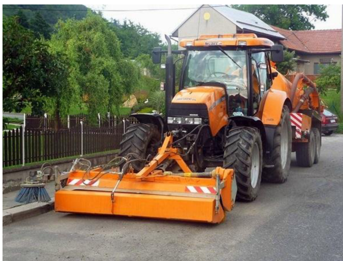
Obr. 8) Upevnění zametače do předního třibodového závěsu [5]
