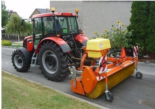
Obr. 9) Upevnění zametače do zadního tříbodového závěsu [5]
