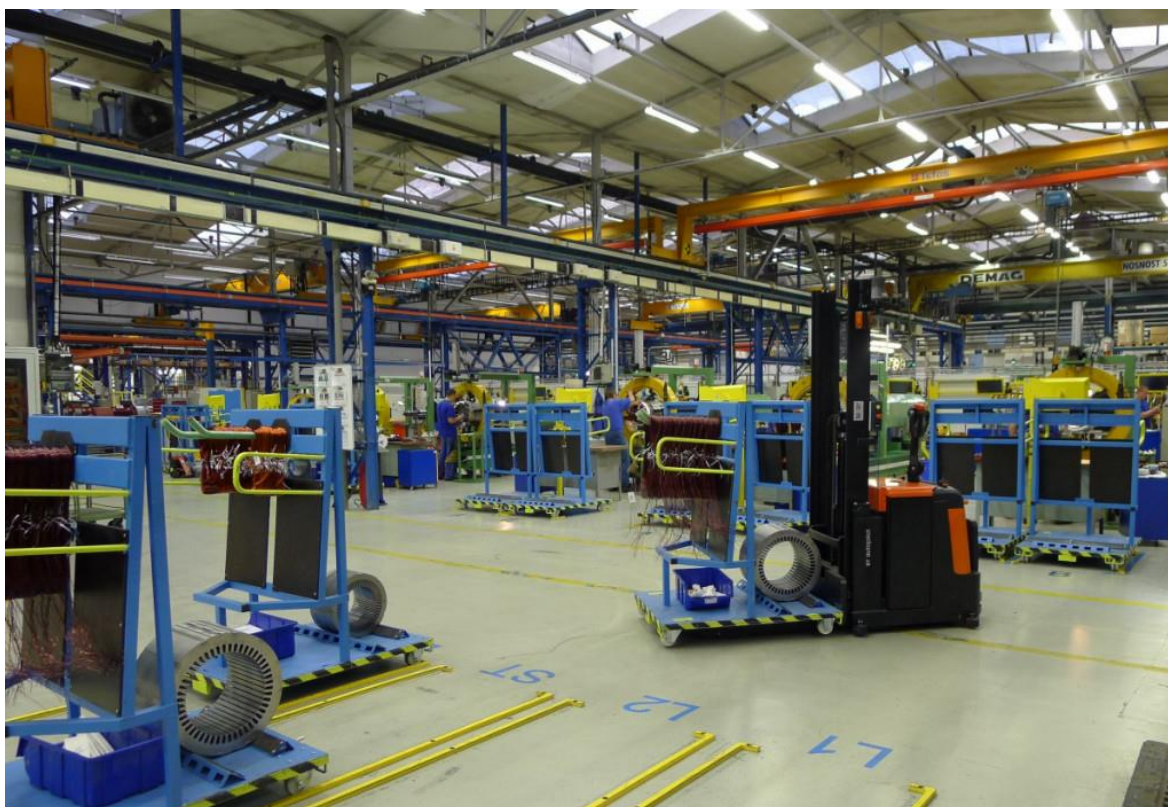
Obrázek 11: Automatizovaný vozík BT Autopilot v závodě Siemens ve Frenštátu Zdroj: Siemens, 2019d
