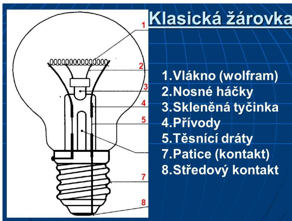
Obr. 7. Schéma klasické žárovky s wolframovým vláknem. (zdroj: slideplayer, 2021)
