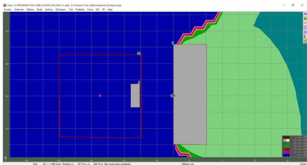
Obr. 6.7.15 Půdorys akustické studie pro buňky, zdroj hluku 120 dB, s izofonami
