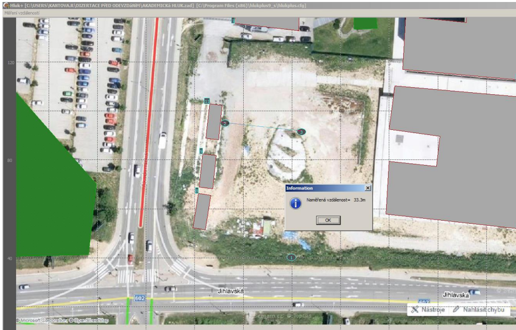
Obr. 7.7 Situace zadaná v SW podpoře Hluk plus – místo měření označeno jako 2, vzdálenost 33,3 m pro ověření vzdálenosti zdroje a místa měření
