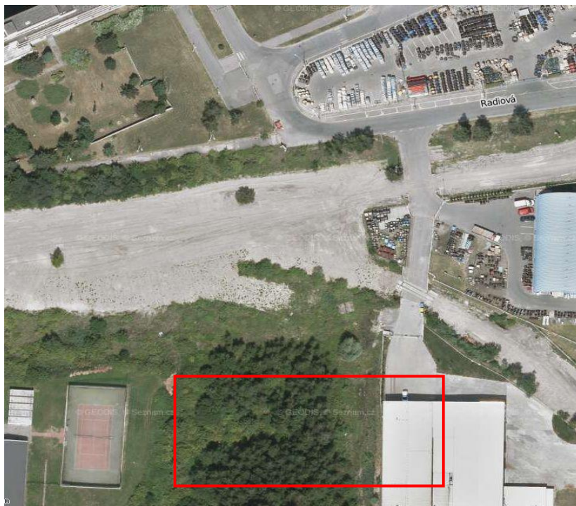
Obr. 4.5.3 Umístění nové výstavby v těsné blízkosti jiného objektu, zde lze v souvislosti s řešením hluku využít stávající porosty jako útlumové prvky [62]
