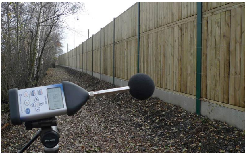
Obr. 3.6.2 Příklad měření útlumu protihlukové stěny hlukoměrem
