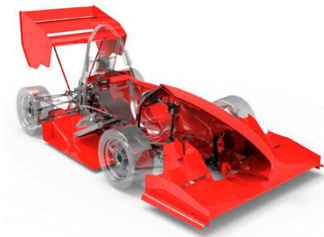
Obr. 15 Aerodynamický paket Dragonu 7 [46]
