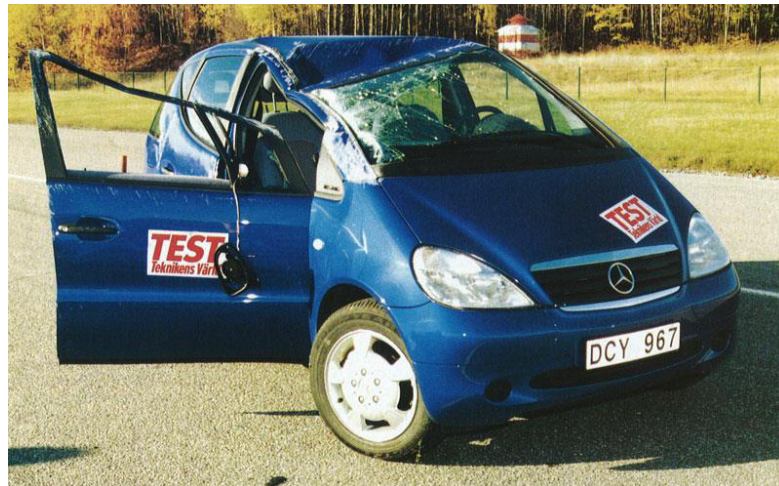
Obr. 22 Mercedes-Benz třídy A po absolvování losího testu [50]
