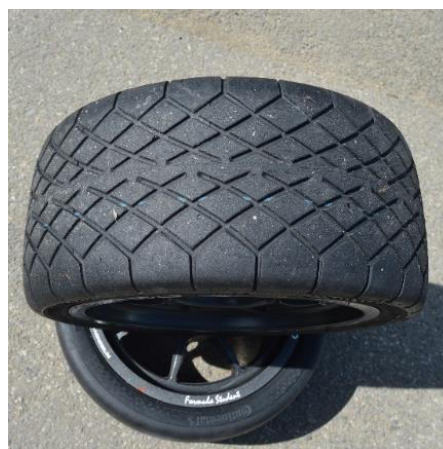
Obr. 11 Pneumatika na mokrý povrch [Vlastní zdroj]
