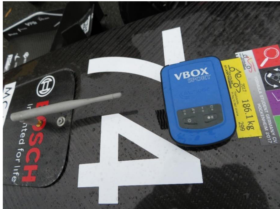
Obr. 34 Vysílač telemetrie a VBOX Sport umístěný na formuli [Vlastní zdroj]
