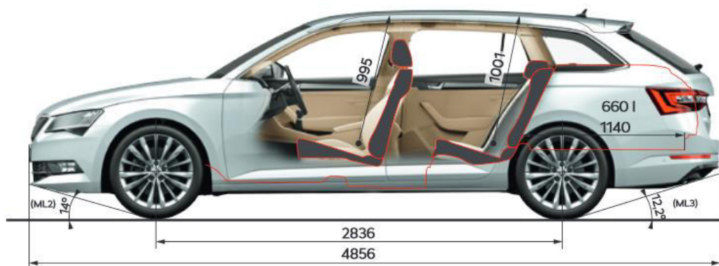
Obr. 32 Délkové a úhlové parametry Škody Superb III verze kombi [54]
