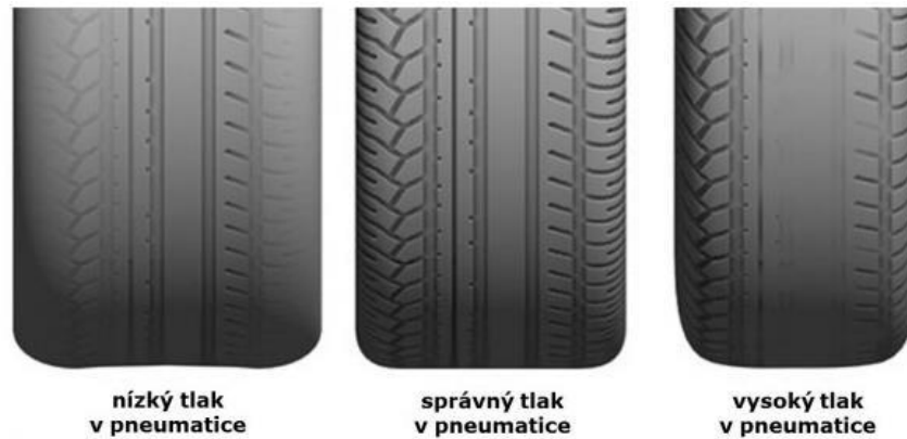
Obr. 7 Opotřebení pneumatik při nesprávném huštění [38]
