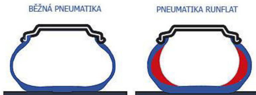
Obr. 8 Porovnání konstrukce pneumatik [39]
