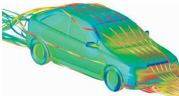
Obr. 21 Simulace proudění vzduchu okolo vozidla [60]
