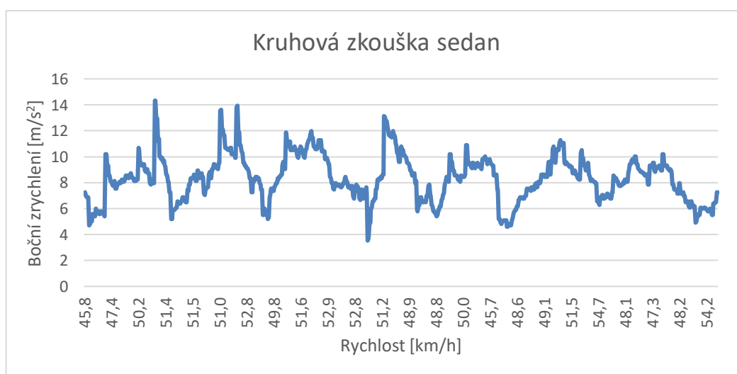
Graf 20 Vývoj bočního zrychlení u verze sedan na průměru 40 m [Vlastní zdroj]
