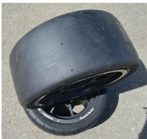
Obr. 12 Pneumatika na suchý povrch [Vlastní zdroj]
