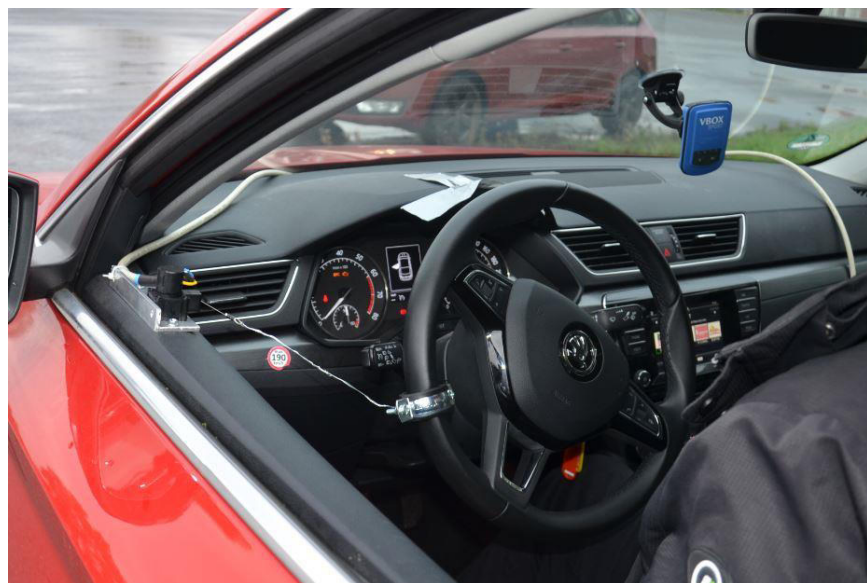
Obr. 35 Umístění zařízení VBOX Sport ve vozidle [59]
