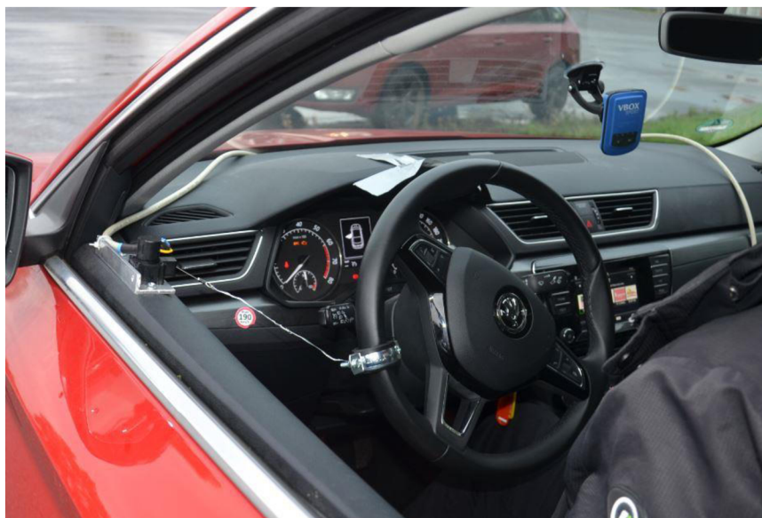
Obr. 35 Umístění zařízení VBOX Sport ve vozidle [59]
