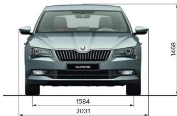
Obr. 29 Šířkové a výškové parametry Škody Superb III verze sedan [54]
