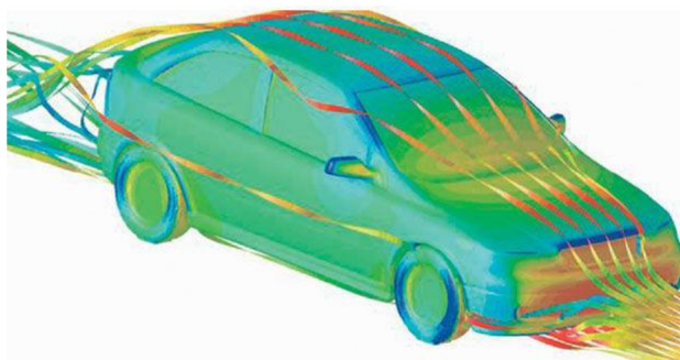
Obr. 21 Simulace proudění vzduchu okolo vozidla [60]
