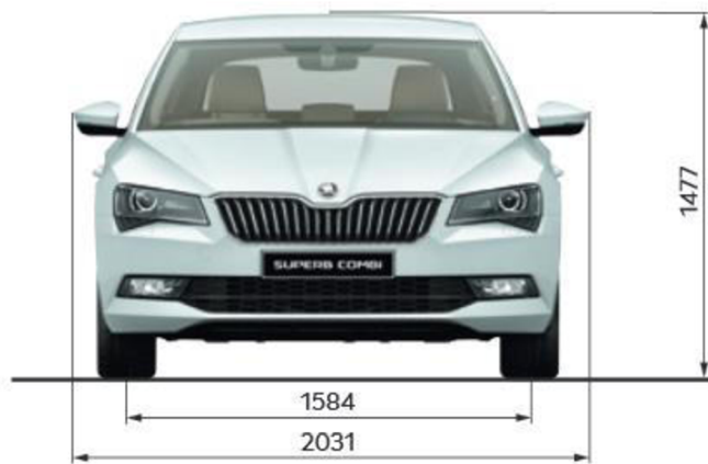
Obr. 31 Šířkové a výškové parametry Škody Superb III verze kombi [54]
