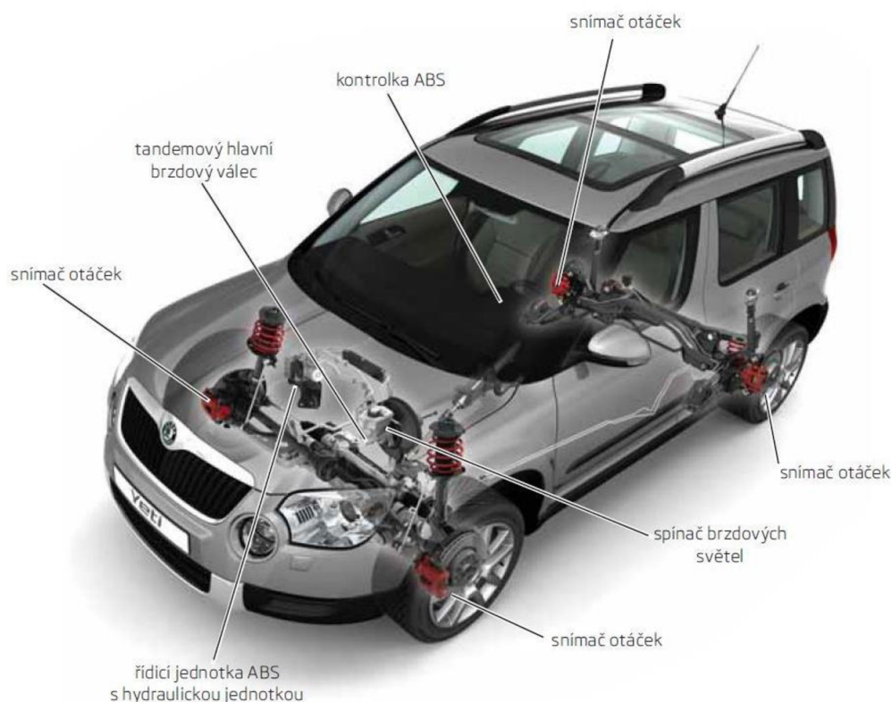
Obr. 18 Prvky asistenčního systému ABS [35]
