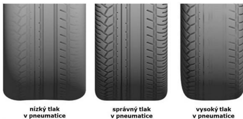
Obr. 7 Opotřebení pneumatik při nesprávném huštění [38]
