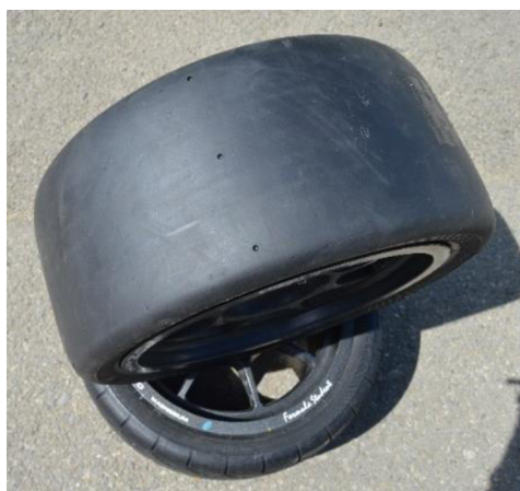
Obr. 12 Pneumatika na suchý povrch [Vlastní zdroj]
