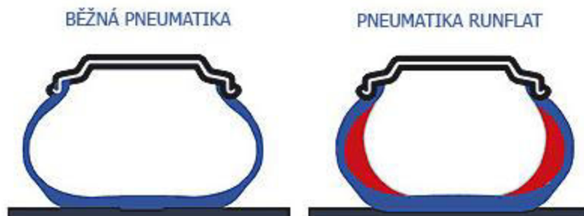
Obr. 8 Porovnání konstrukce pneumatik [39]
