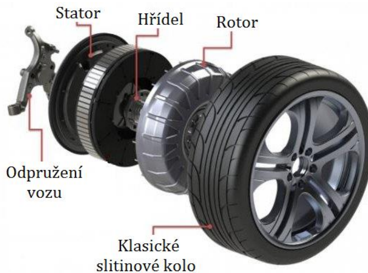
Obr. 10: Elektromotor zabudovaný v kole
