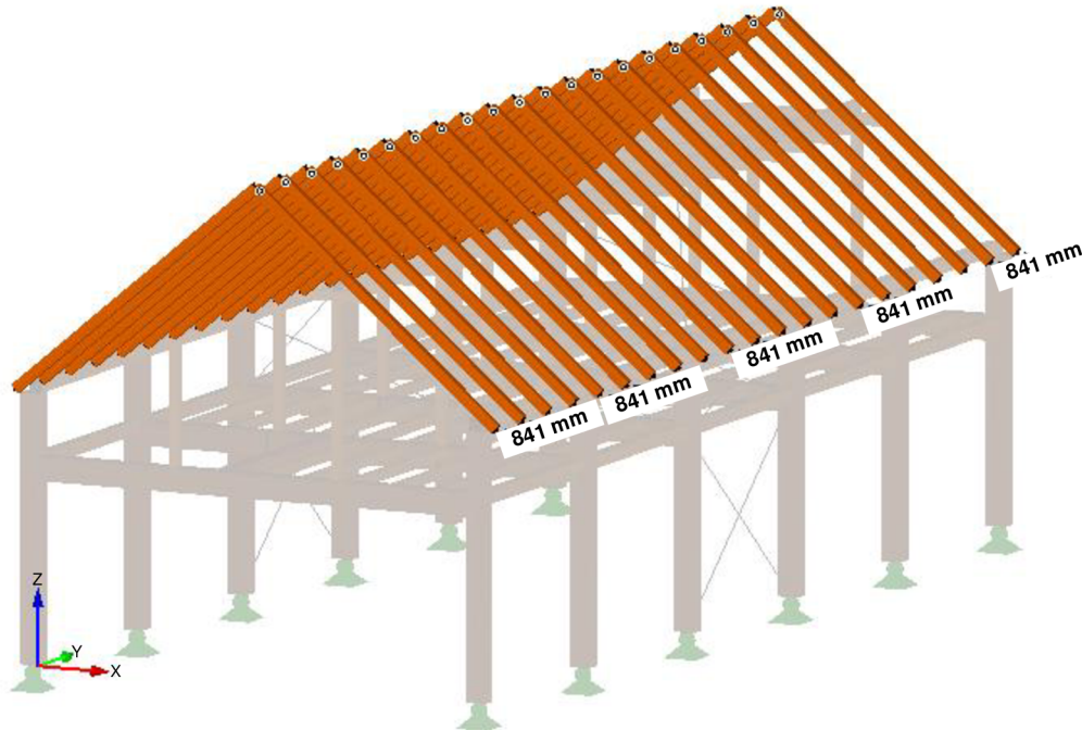
Obrázek 17 - Krokve 100x160 mm
