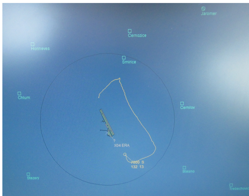
Obr. 6 – zobrazení výstupu přehledového zařízení ERA na LKHK
