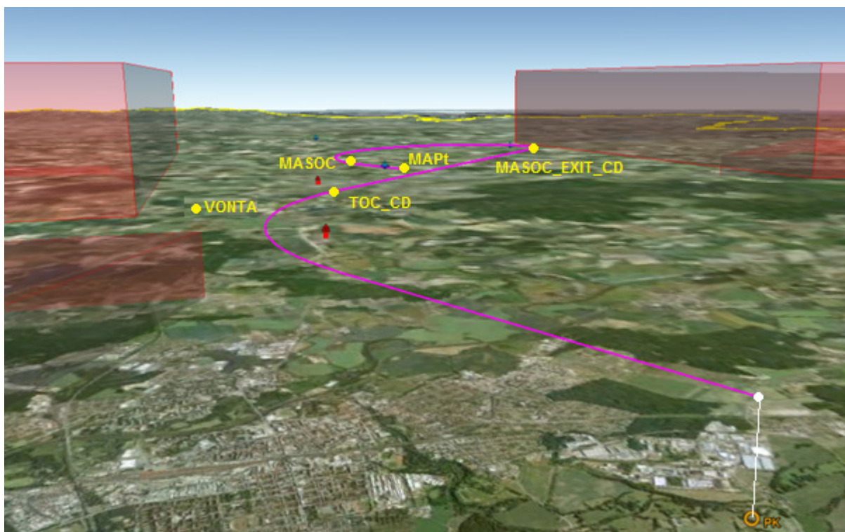
Obr. 17 – prostorové zobrazení postupu nezdařeného přiblížení (kat. A, B) v GE
