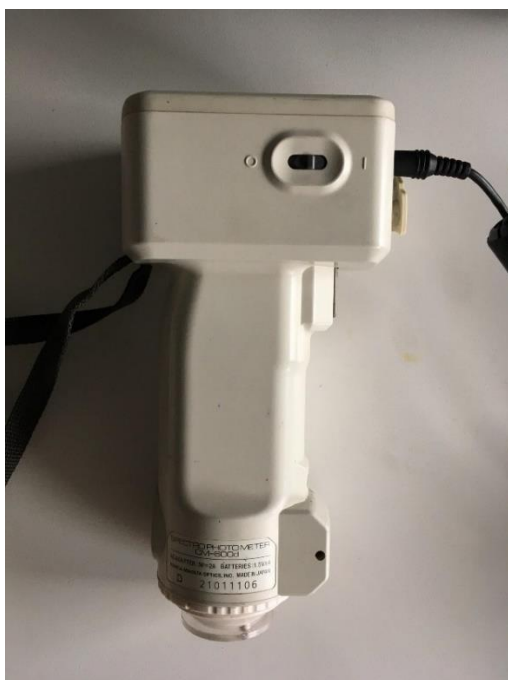
Obrázek 10, 11. Spektrofotometr Konica Minolta CM-700d (foto autor).
