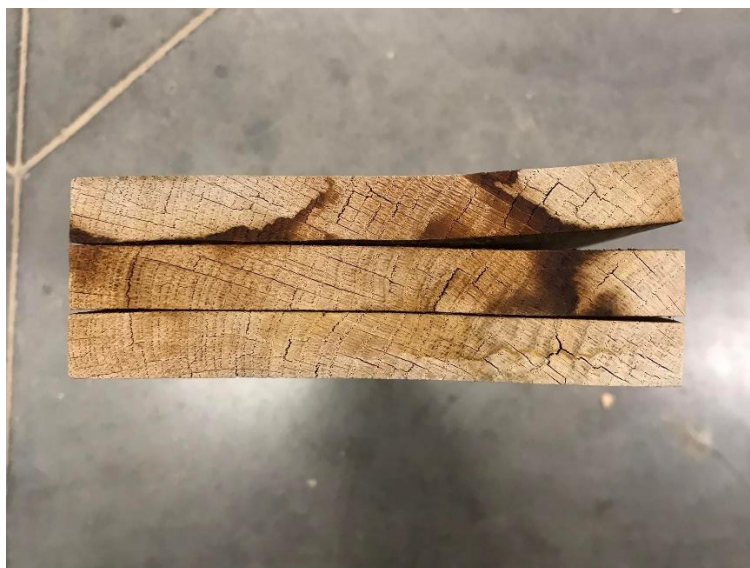
Obrázek 18. Delaminace vzorku po umělém stárnutí s postřikem (foto autor).
