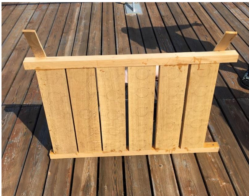
Obr. č.: 16 Vzorky ve vnější expozici (foto autor)
