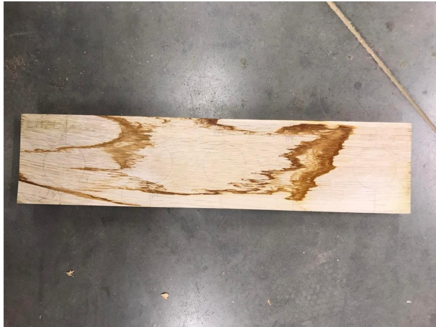
Obrázek 21. Vzorek po umělém stárnutí s vodním postřikem (autor).
