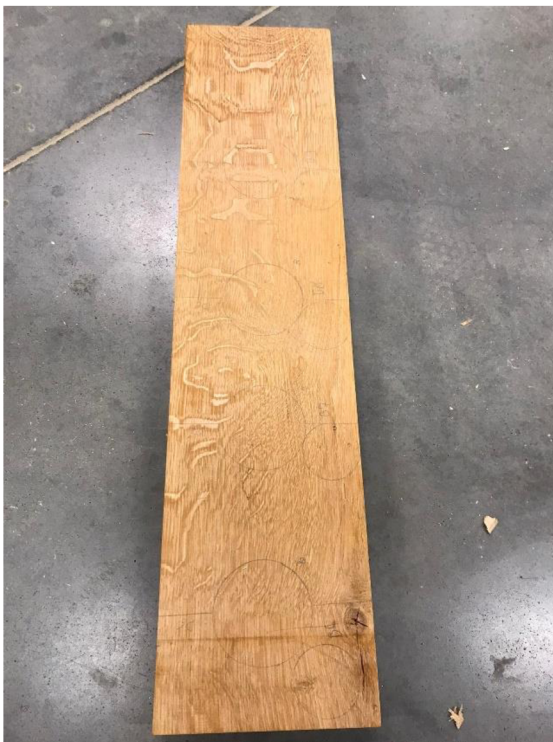
Obrázek 19. Vzorek po umělém stárnutí bez postřiku (autor).
