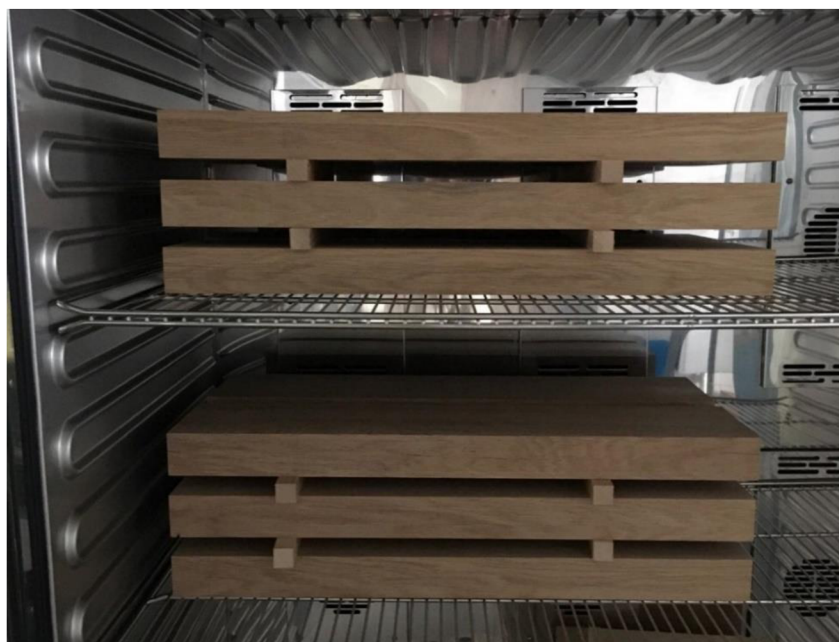
Obrázek 9. Klimatizační komora se vzorky (foto autor).
