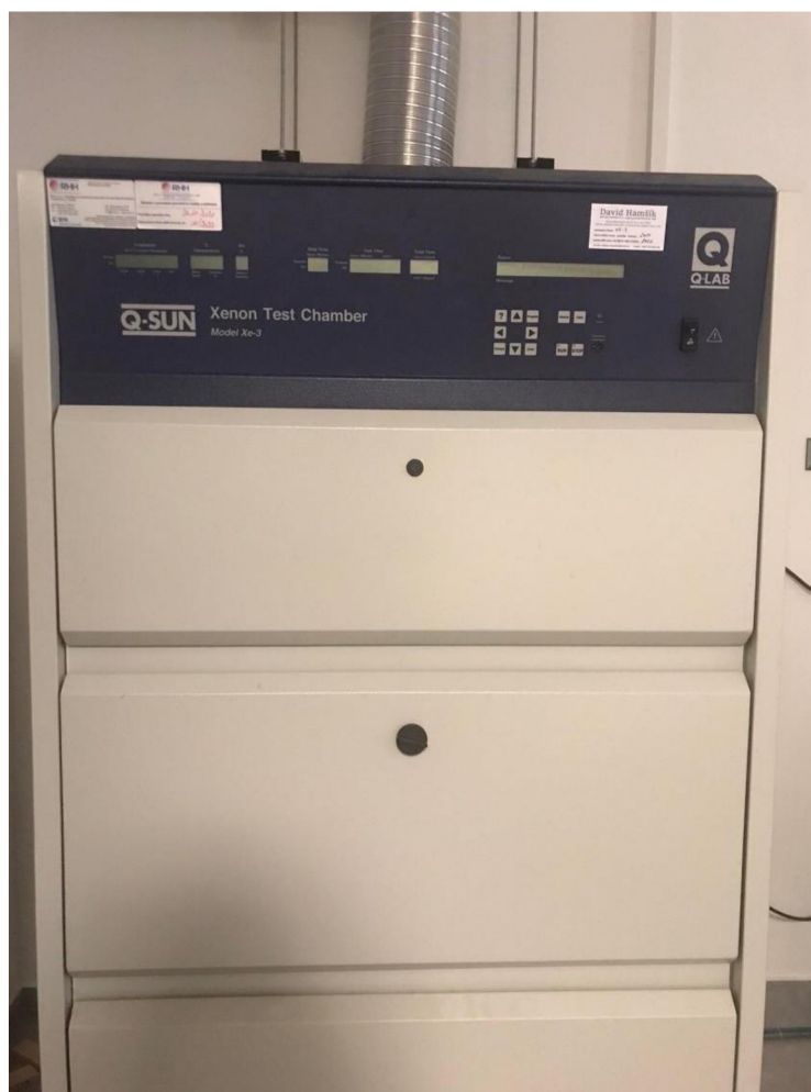
Obrázek 17. Xenonová oblouková komora Q-SUN Xe-3 (foto autor).
