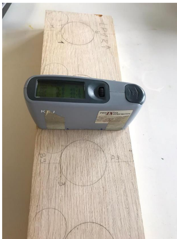
Obrázek 12. Leskoměre KJS 268-F2 (foto autor).
