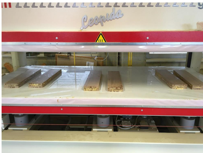
Obrázek 8. Hydraulický lis se vzorky (foto autor).
