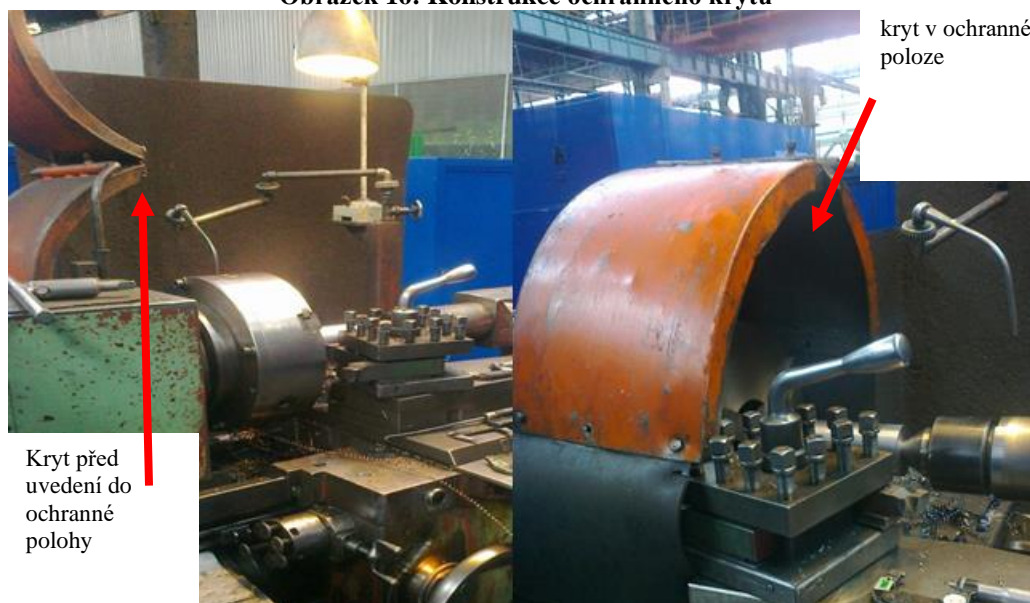
Obrázek 16: Konstrukce ochranného krytu
