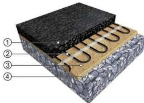
Obr. 1. 13 Instalace do asfaltu, zdroj: [35]
