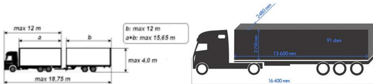
Obr. C. 20 Max. rozměry přívěsu a návěsu, zdroj: [10]
