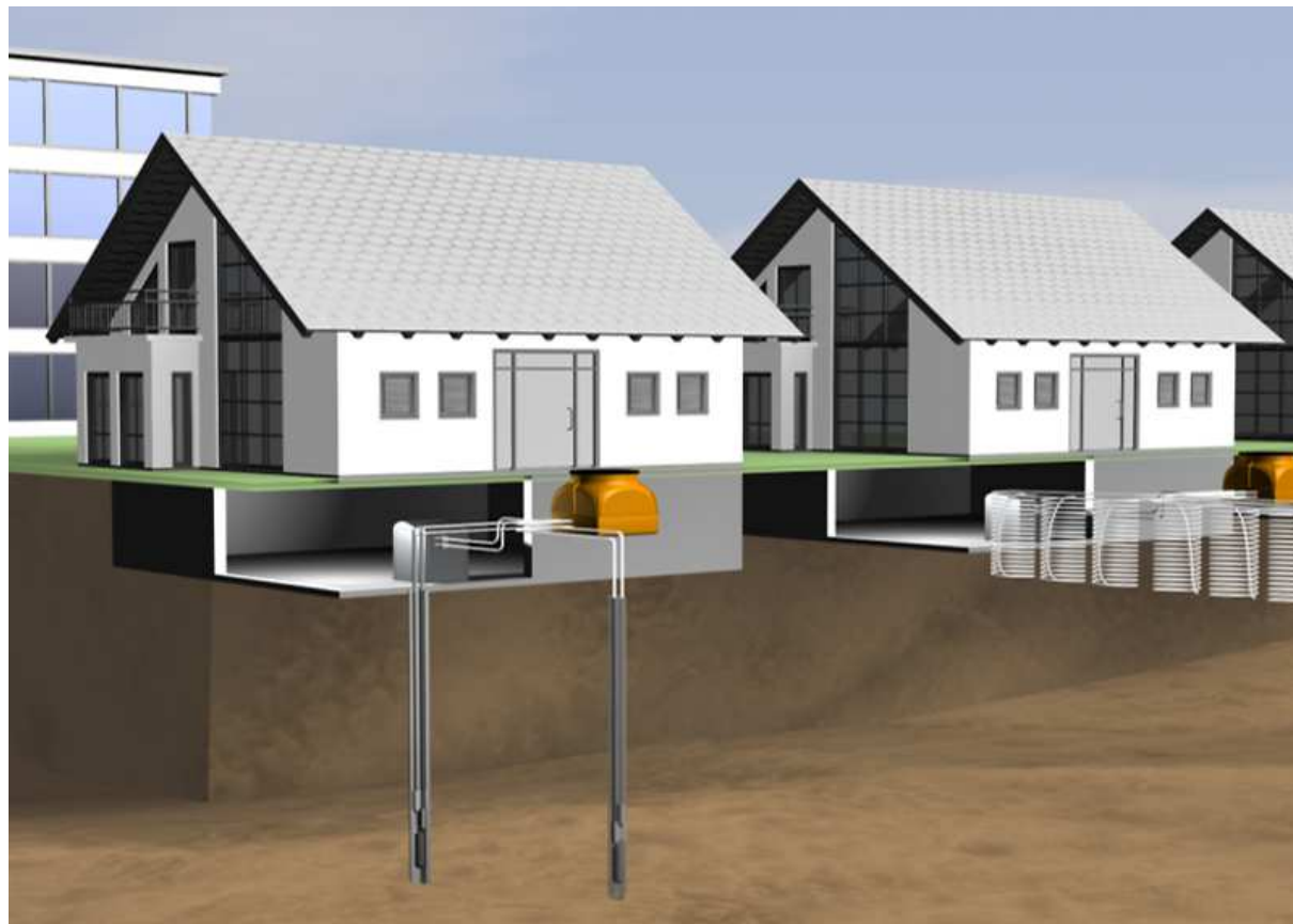
Obr. 1. 15 Geotermální energie, zdroj: [37]
