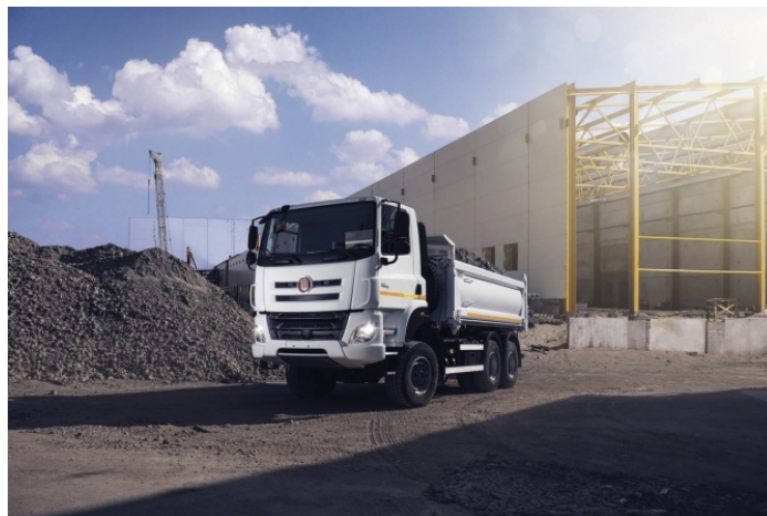
Obr. G. 5 Nákladní automobil TATRA PHOENIX 6x6 s třístranným sklápěčem T158-8P6R33.341, zdroj: [22]
