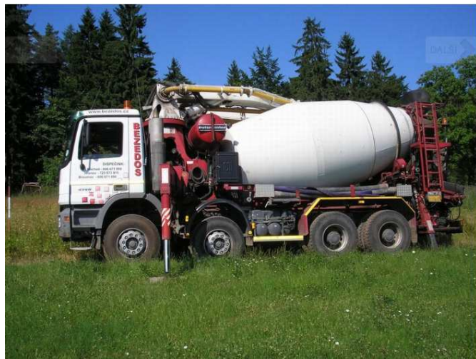
Obr. G. 6 Čerpadlo s domíchávačem MERCEDES BENZ PUTZMEISTER 31, zdroj: [23]
