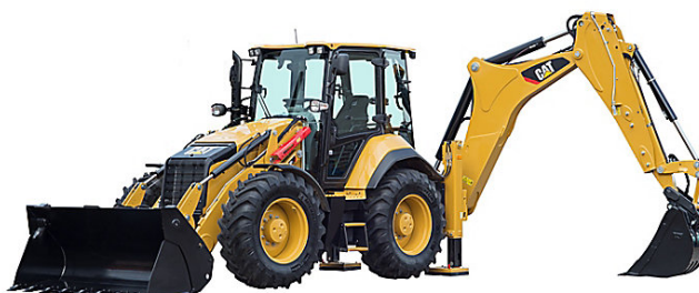
Obr. G. 2 Rypadlo-nakladač CATERPILLAR 444F2, zdroj: [20]
