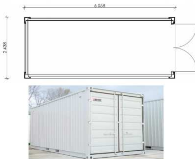
Obr. F. 3 Skladový kontejner, zdroj: [13]
