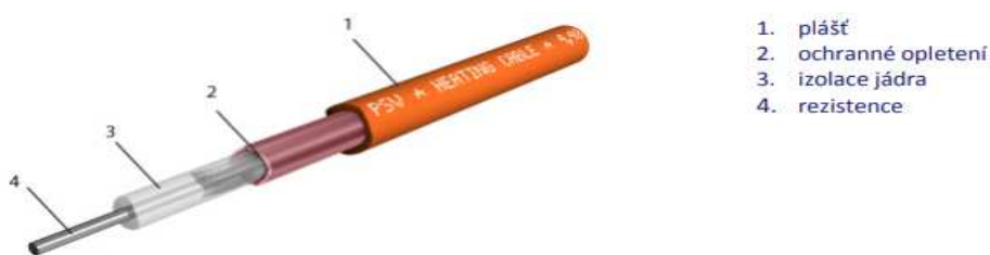
Obr. I. 4 Odporové kabely, zdroj: [35]
