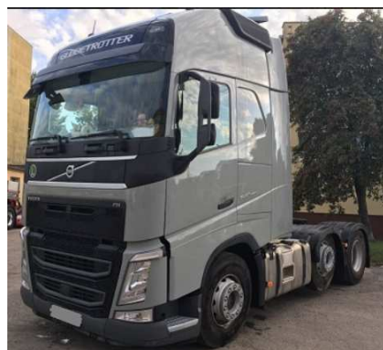
Obr. G. 14 Tahač VOLVO FH540 6x2 a 3–nápravový velkoprostorový valníkový návěs SCHWARZMULLER RH 40 se stahovatelnou plachtou, zdroj: [27]
