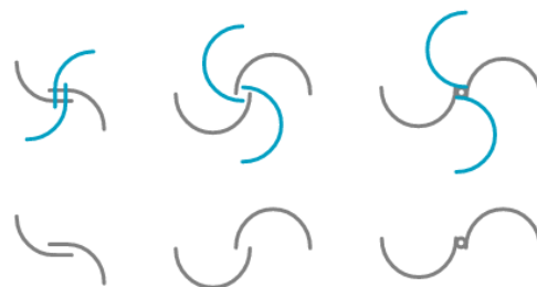
Obr. 16 Jednotlivé konfigurace Savoniova rotoru [46]
