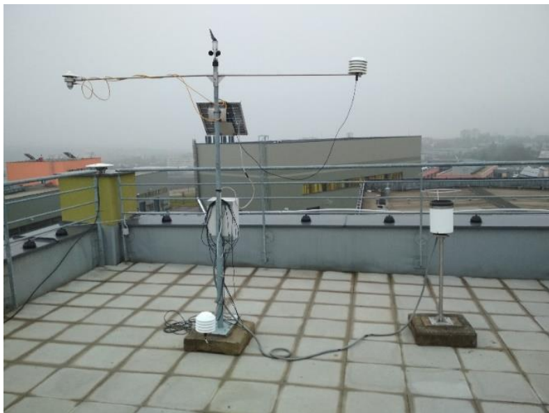
Obr. 29 Meteorologická stanice umístěná na střechu budovy P4
