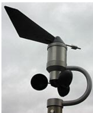
Obr. 31 Miskový anemometr W2
