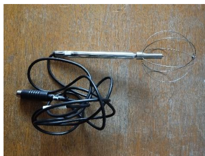
Obr. 38 Sonda se žhaveným drátkem Testo
