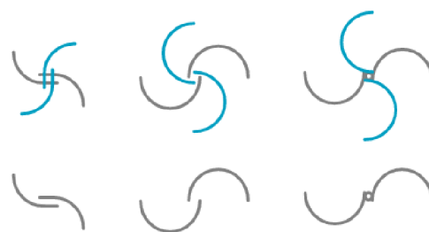
Obr. 16 Jednotlivé konfigurace Savoniova rotoru [46]
