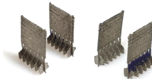
Obr. 5-35 Stěna tvořená dvojitým skenováním laseru
