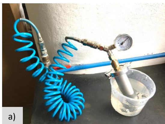
Obr. 5-55 a) Měřicí aparatura těsnosti tenkých stěn; b) vzorky stěn 0,13 až 0,45 mm
