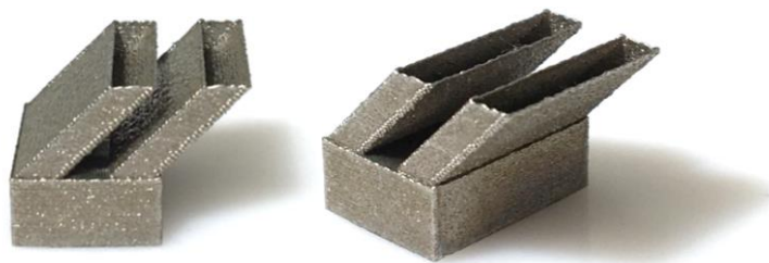
Obr. 5-31 Tenká stěna pod úhlem 45°
