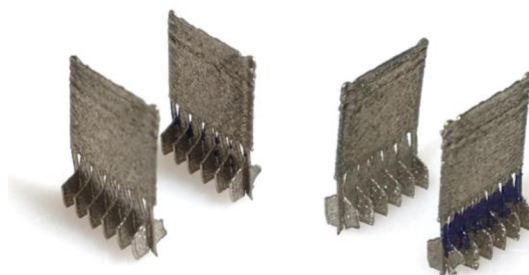
Obr. 5-35 Stěna tvořená dvojím skenováním laseru
