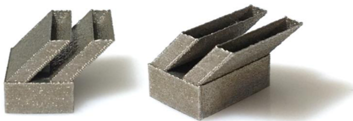
Obr. 5-31 Tenká stěna pod úhlem 45°
