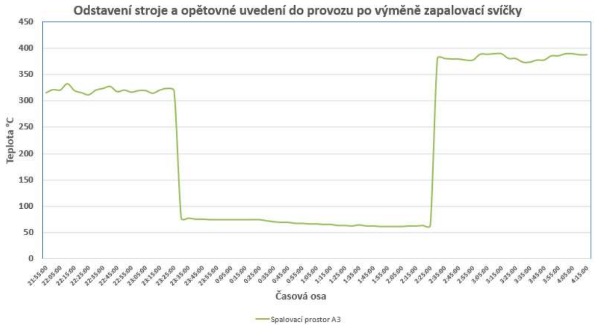
Graf č. 4 Vývoj teploty válce A3 před poruchou a po výměně svíčky
