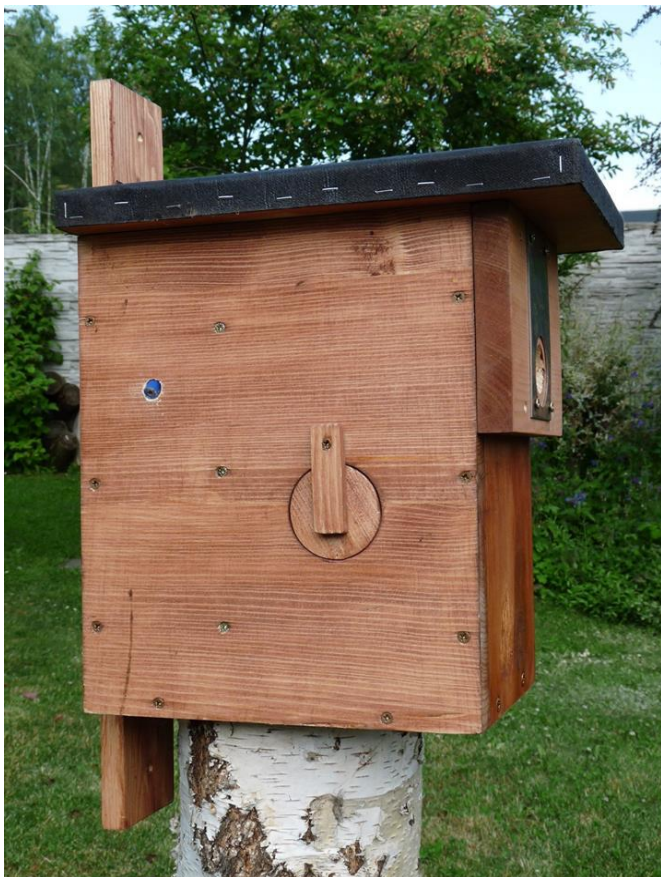
Obr. 10. Pohled na zařízení chytré ptačí budky (foto: M. Zárybnická)
