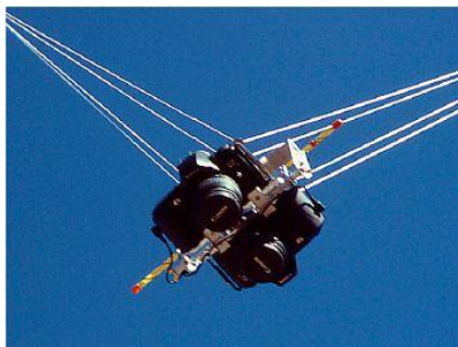
Obr. 3.3 Závěsná souprava pro více kamer [1].
