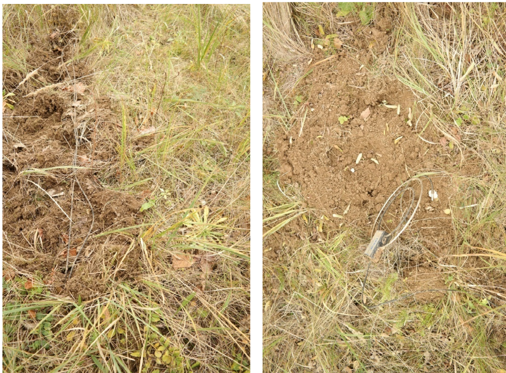
Obr. 47 a 48. Dokumentační fotografie poškozování půdních čidel divokými prasaty.
