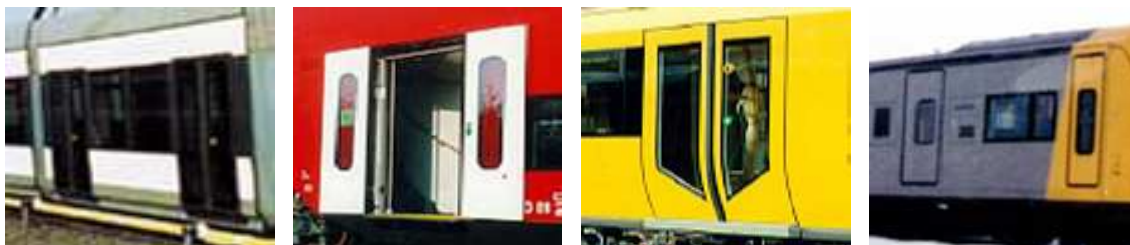
Obrázek 2: Dvevní systémy pro hromadné dopravní prostředky
