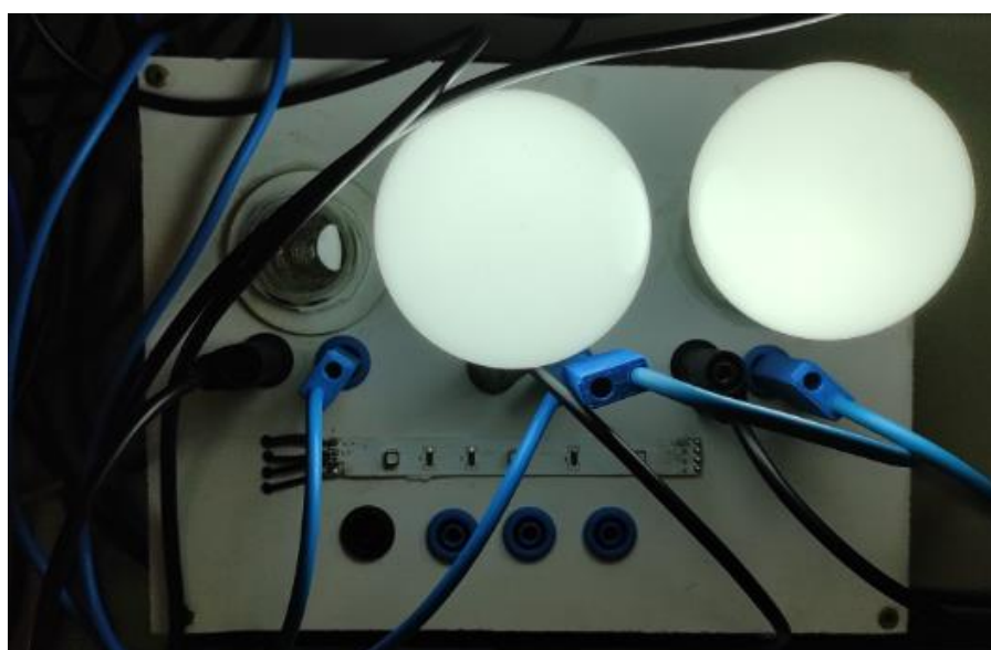
Obrázek 81: Fotografie zapojeného panelu se svítlíky
