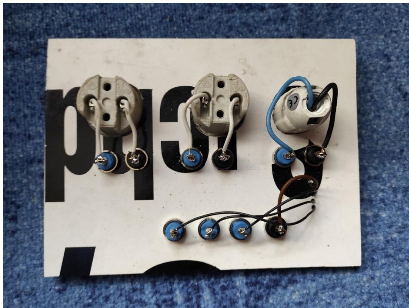
Obrázek 71: Fotografie propojení svítidel a LED pásky s konektory
