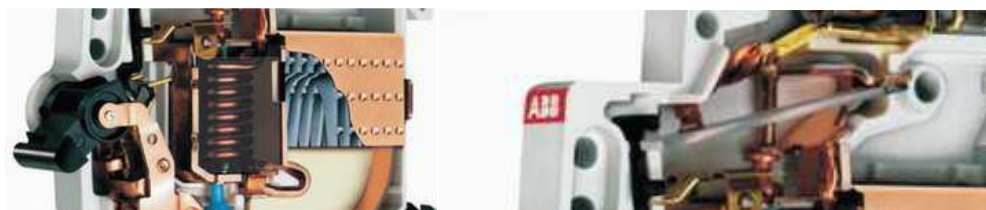
Obrázek 10: Zkratová spoušť (vlevo) a nadproudová spoušť (vpravo) [1]
