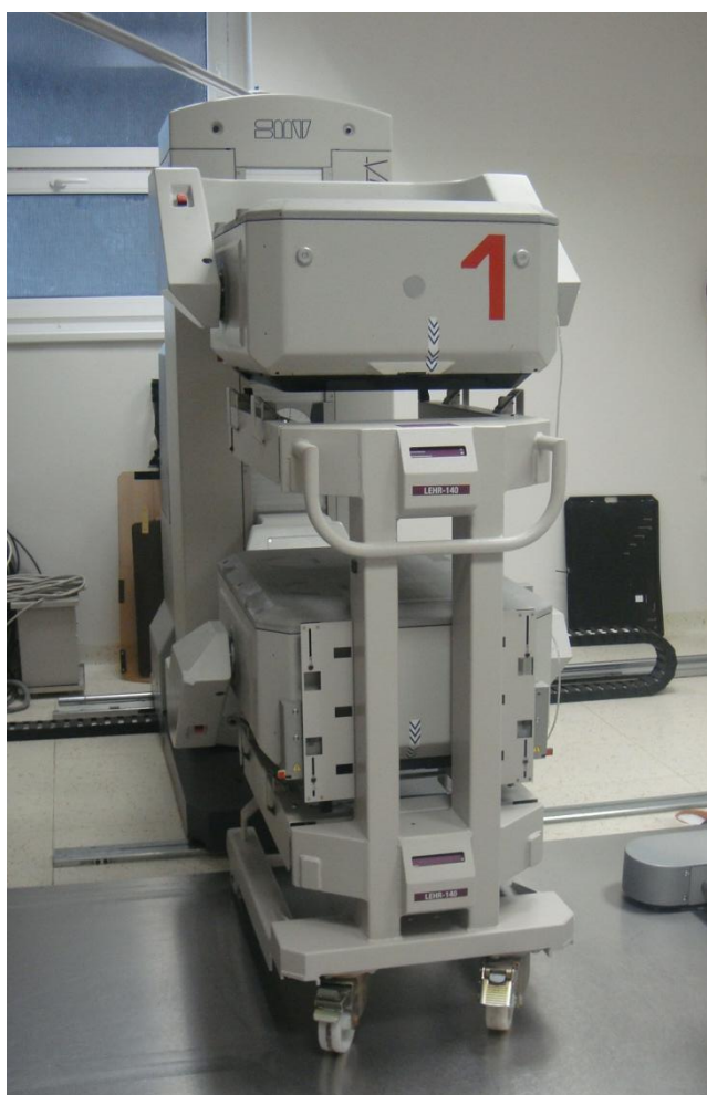
Obr. č. 8: Vozík připravený na výměnu kolimátorů.
