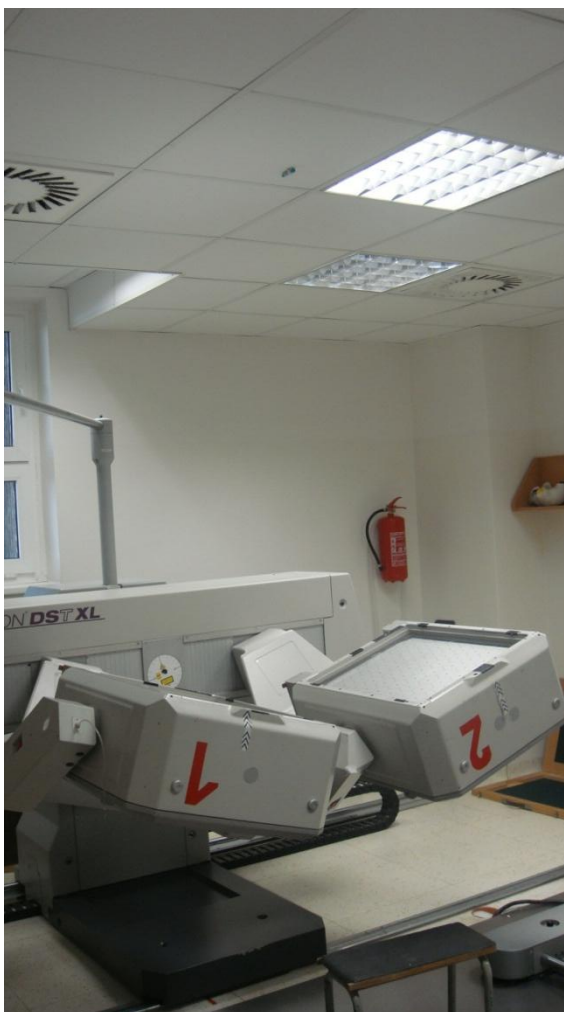
Obr. č. 10: Detektory v poloze pro měření s umístěným bodovým zdrojem na stropě
